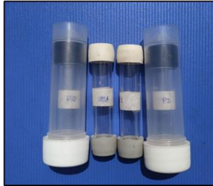
Foto 6. Tubos pasivos para análisis de NO 2 y SO 2
