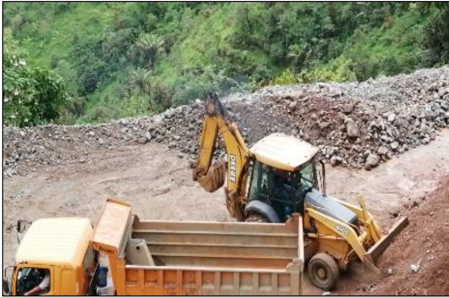
Foto 18. Carga de mineral en volquetes para su posterior traslado a plantas de beneficio
