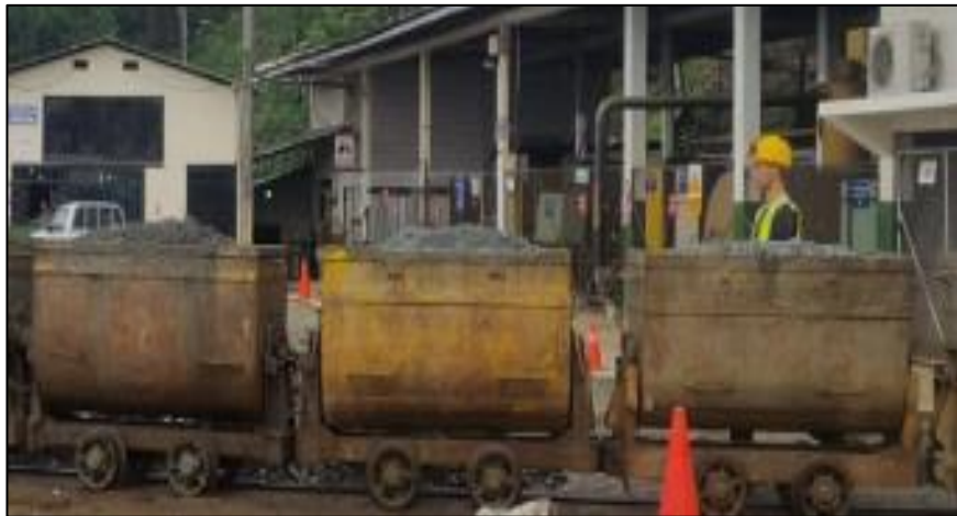
Foto 16. Transporte manual en carros metálicos de 1ton de capacidad
