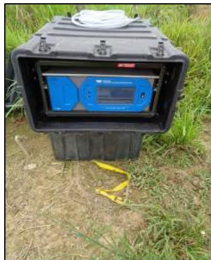
Foto 7. Equipo de infrarrojo No Disperso para medir CO
